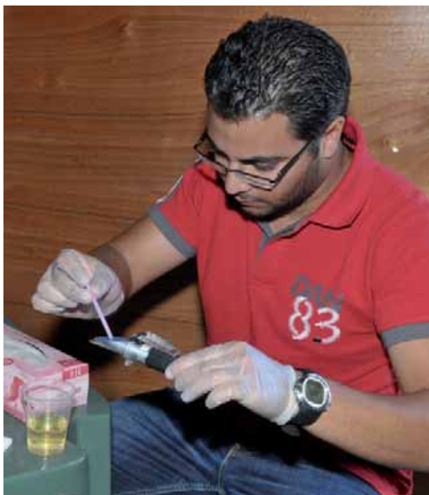
Ein DAN Europe Forscher führt die Messung der Dichte des Urins während eines DAN Forschungssevent durch. Dieser Test bestimmt das spezifische Gewicht des Urins, welches vom Hydratationszustand des Tauchers abhängt.
